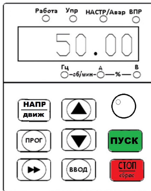
Рис. 3-1. Внешний вид панели управления преобразователя частоты
